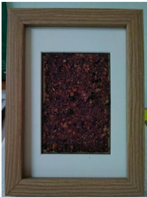
Probefläche aus Früchtetee-Putz
